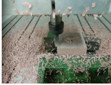
6mm 平刀 3D 曲面粗加工
